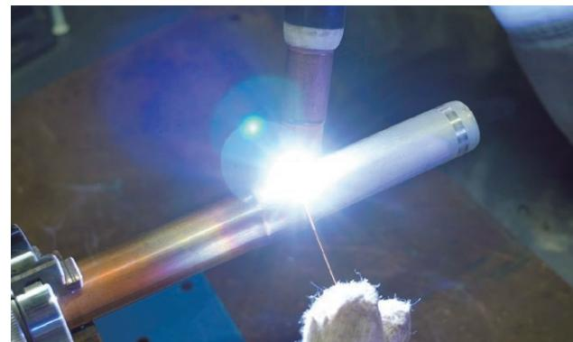
銅鉄合金を用いた銅とステンレスの溶接
