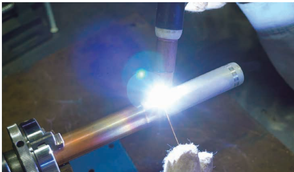
銅鉄合金を用いた銅とステンレスの溶接
