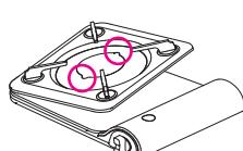
①しる受けにある電極位置凹部2箇所のうちどちらかを電極の位置に合わせます。
