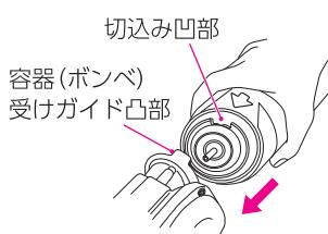
⑥ 右図のように容器(ボンベ)の頭近くに手を添えて、そのまま水平にスライドさせ、完全にマグネットに密着するまで押しつけて装着します。
