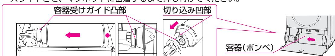
※容器(ボンベ)が正しくセットされているときは、容器(ボンベ)の後ろ側
