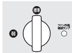
○ 燃焼停止後、約60秒間はファンが回転し、ファン作動確認ランプ(緑)が消灯します。
