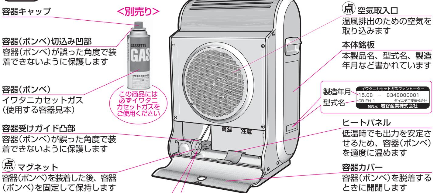
◆容器(ボンベ)装着時にマグネットに付着物がないか確認してください。
