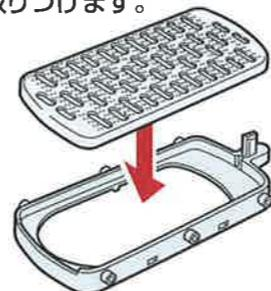
**△注意** おろしプレートとカッタープレートはかさねて取り付けないでください。けが・故障の原因になります。
