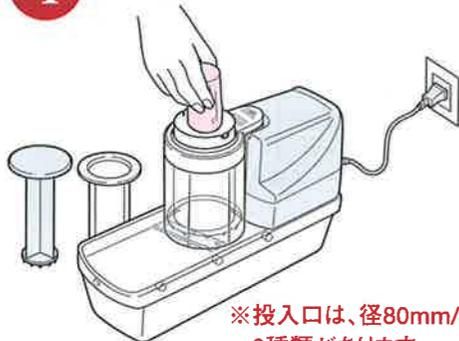
**3** カッタープレートを取りつけたプレート枠を外容器に取りつけ、フレームカバー、本体をセットします。
