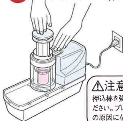
△注意 押込棒を強く押し過ぎないでください。プレートの変形、ロックの原因になります。
