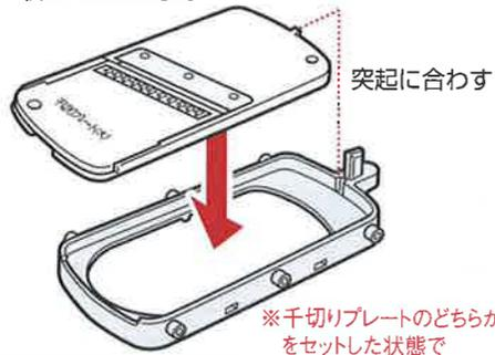
**△注意** おろしプレートとカッタープレートはかさねて取り付けしないでください。けが・故障の原因になります。
