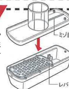
5 フレームカバーに本体を取りつけます。本体の凹部とカバーの凸部を合うように置いてください。
