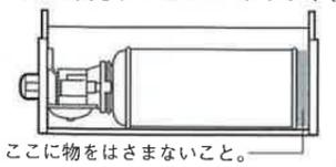
**注意** ●容器(ポンベ)を取りはずした後も、こんろの配管には少量のガスが残っています。危険防止のため、もう一度残っているガスを燃焼させてください。
