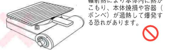
輻射熱により本体に熱がこもり、本体焼損や容器（ボンベ）が過熱して爆発する恐れがあります。
