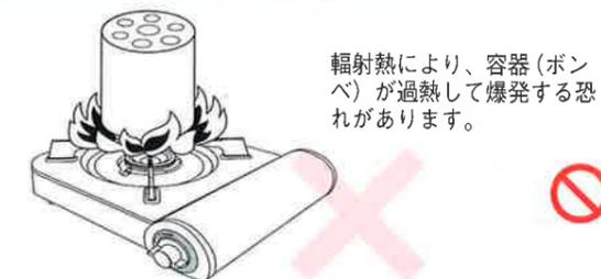
輻射熱により、容器（ボンベ）が過熱して爆発する恐れがあります。
