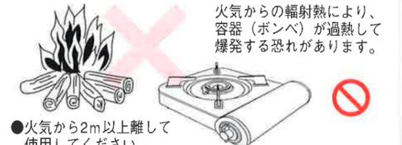
火気からの輻射熱により、容器（ボンベ）が過熱して爆発する恐れがあります。
