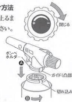
注意: ボンベを傾けて装着しますとトーチ配管内に液状ガスが入り、点火時に炎が大きくなるなど危険です。傾けないように装着してください。
