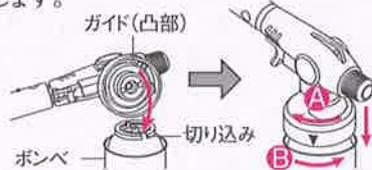
注意:ボンベを傾けて装着しますとトーチ配管内に液状ガスが入り、点火時に炎が大きくなるなど危険です。傾けないように装着してください。
