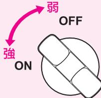
点火つまみを「ON」方向に回すと火力を強く、「OFF」方向に回すと弱くすることができます。
