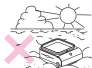
夏の砂浜やアスファルトなど日光によって容器(ボンベ)が過熱するような場所では使用しないでください。
