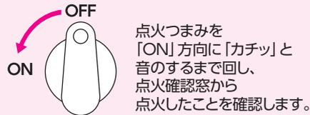
点火つまみを「ON」方向に「カチッ」と音のするまで回し、点火確認窓から点火したことを確認します。
