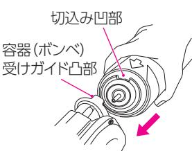
⑥ 右図のように容器(ポンベ)の頭近くに手を添えて、そのまま水平にスライドさせ、完全にマグネットに密着するまで押しつけて装着します。
