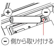
容器(ポンベ)を取り外し、本体を裏返します。電池ボックスに乾電池を正しく取り付けてください。
