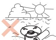
夏の砂浜やアスファルトなど日光によって容器(ボンベ)が過熱するような場所では使用しないでください。
