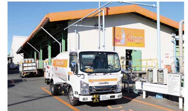
LPガスの3次基地とバルクローリー車
