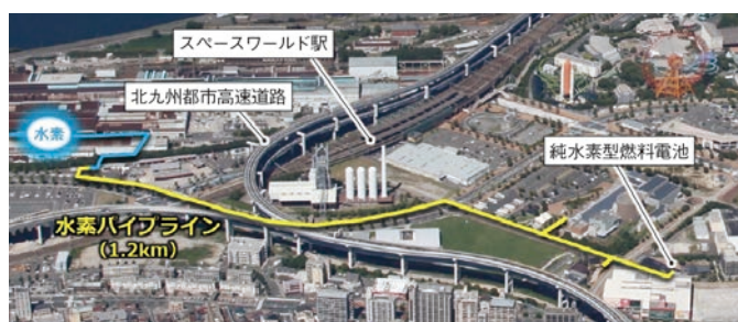
パイプラインによる水素供給で住宅などの電源をまかなう
