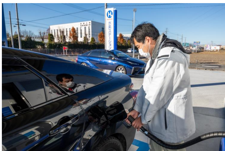
図3 燃料電池自動車へ水素が充填される様子
