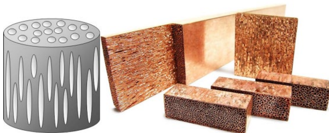
ロータス金属：一方向に伸びた無数の気孔を有する
