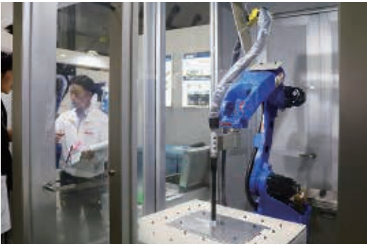
「ガス&ロボット」のコンセプトで開発されたロボットによるドライアイス洗浄技術
