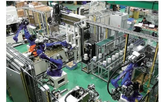
自動車排気系部品の自動組立ロボット
